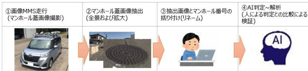
MMS 車両で撮影した画像からマンホール蓋の緯度経度を抽出し、その後、千葉市で保有している下水道台帳データと突合した上でA I を用いてマンホール蓋の型式判定等を行う。
